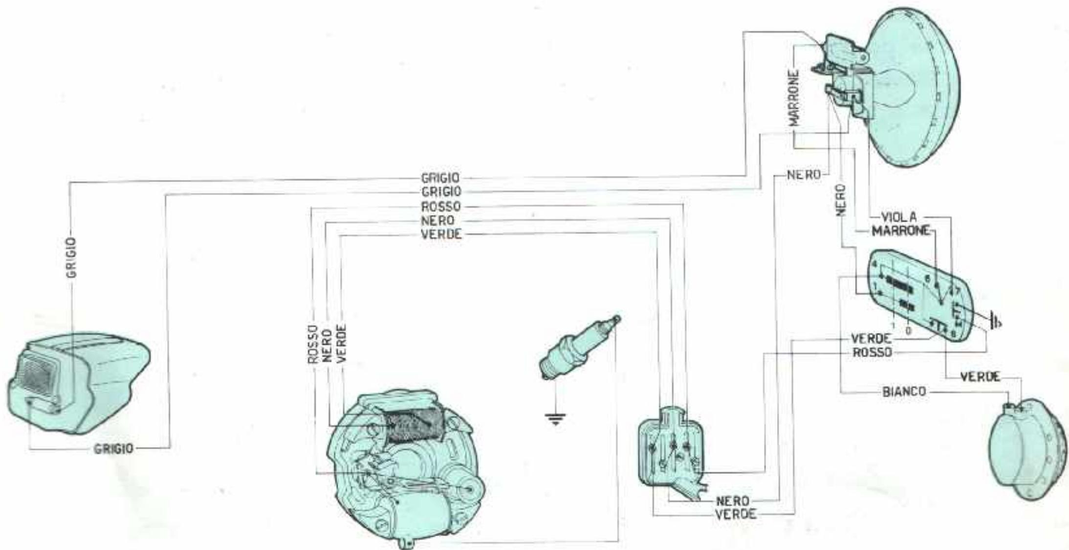
Figg. 19 - 20 - Installazione impianto elettrico sulla moto (fig. di pag. 36) e schema dei collegamenti (fig. della presente pagina).
