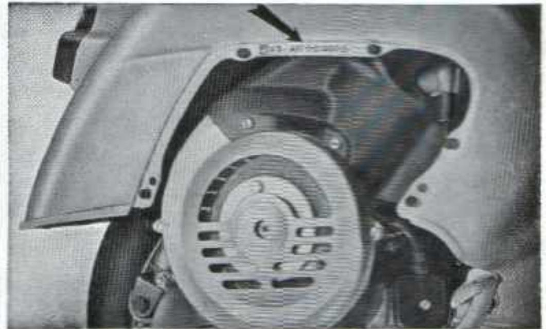
Fig. 23 - Stampigliatura sul telaio
