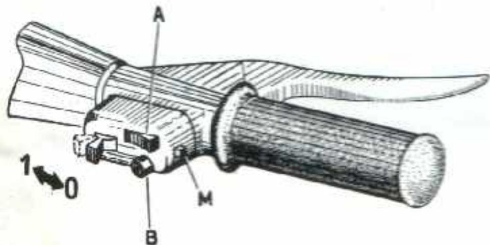
Fig. 21 - Posizioni del commutatore
