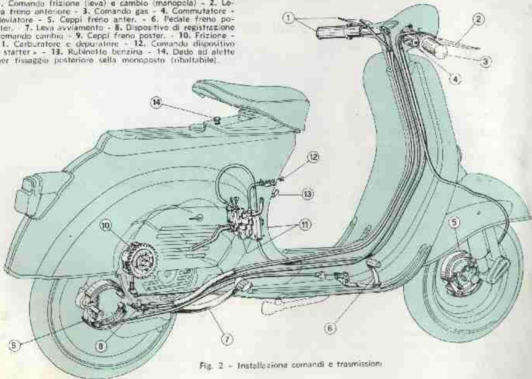
Fig. 2 - Installazioni comandi e trasmissioni.
