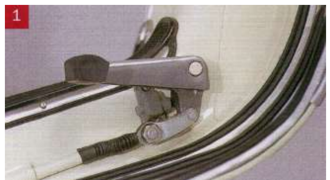
Nella foto 1 si vedono l'interruttore dello stop ed il soffietto di protezione per il filo del freno posteriore.
